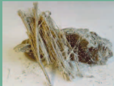
La fibrosità dell'amianto : in 1 cm si possono allineare 250 capelli, 500 fibre di lana oppure ben 335.000 fibrille di amianto.
