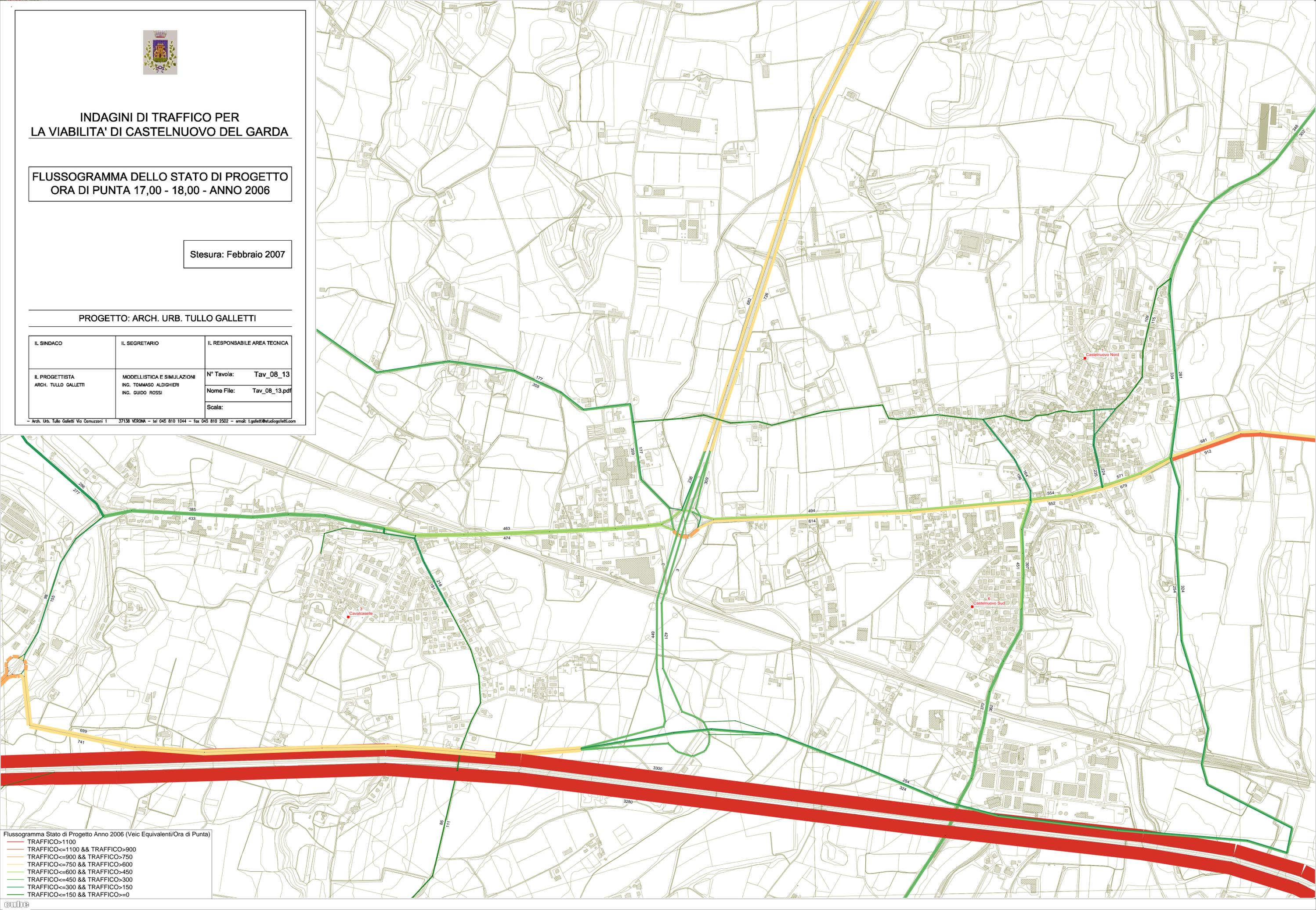
Flussogramma Stato di Progetto Anno 2006 (Veic Equivalenti/Ora di Punta)
